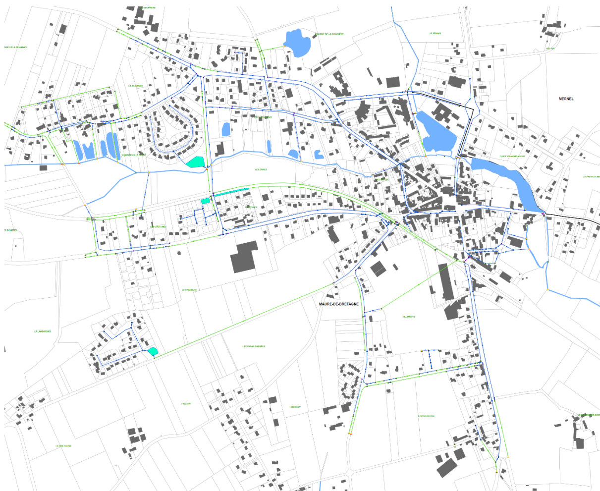
Plan du réseau EP sur Maure-de-Bretagne - Source : schéma directeur EP de Maure de Bretagne - 2017
